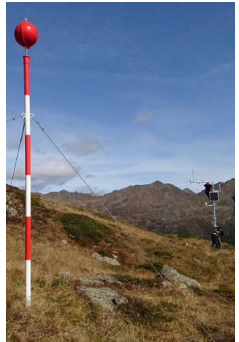
Digitale Schneemesstation mit zusätzlicher Schneestange im farblichen 50 Zentimeter Abstand
