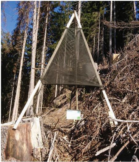
System TRINET mit Holzkonstruktion
