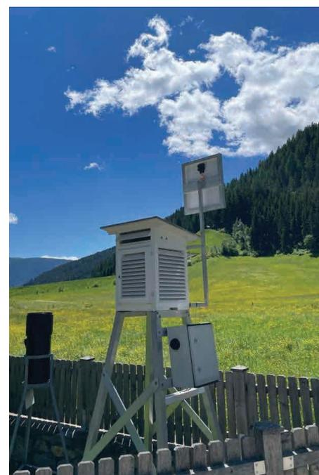
Wetterstation der Hydrologie mit Solarpaneel, Datenlogger und Regenmesser!
