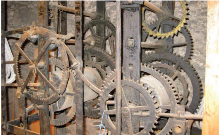
Links das Schlagwerk, rechts das Uhrwerk der Turmuhr
