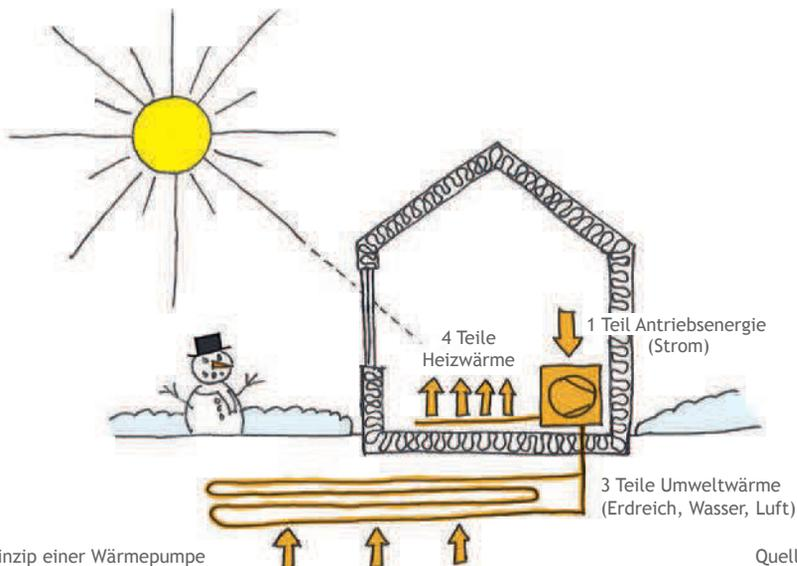
Das einfache Prinzip einer Wärmepumpe
